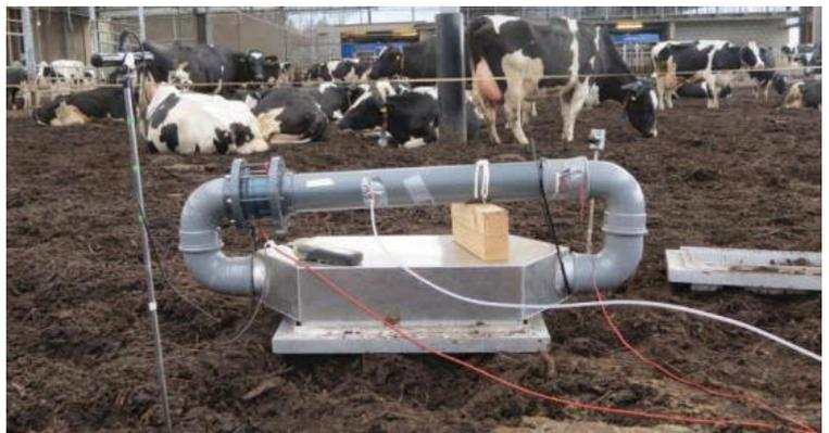
Abbildung 18: Geschlossene Strömungskammer mit Umluftbetrieb zur Messung der CO<sub>2</sub>-Produktion durch Einstreumaterialien.
