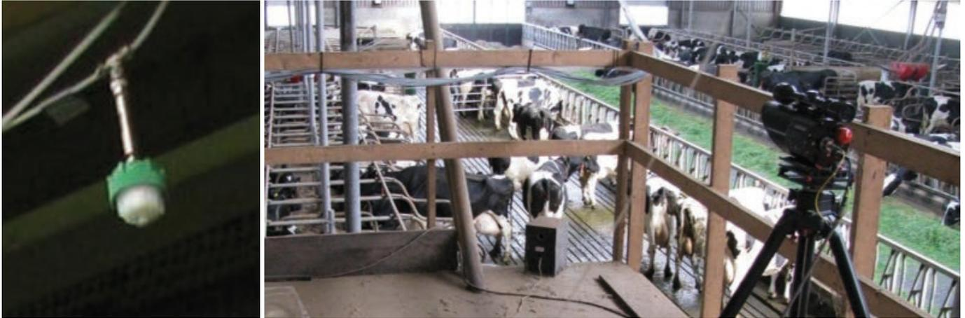
Abbildung 15: Links: Probenahmestelle mit kritischer Düse und Staubfilter. Rechts: Open-Path-Lasersystem
